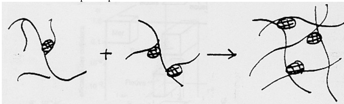
Fig. 16. Représentation schématique de la formation de floc.
