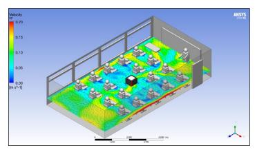
Die bodennahe Erfassung und die Rückführung der gereinigten Luft über die Geräteoberseite begünstigen die Fallrichtung der Tröpfchen und sorgen für eine walzenförmige Durchströmung des Raumes. Experten sehen eine Luftwechselrate zwischen vier und acht vor. Als Fachleute für reine Luft beraten wir unsere Kunden professionell und ermitteln die Gerätekombination, die sich für die jeweiligen Gegebenheiten am besten eignet.
