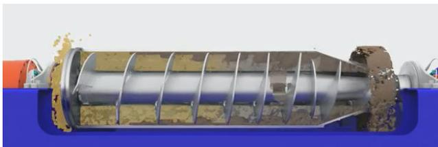
Figure 1. Configuration à cône court
