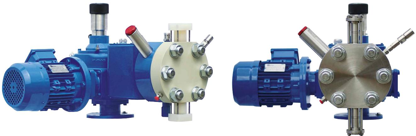
Conçu pour produire de faibles émissions sonores et minimiser la consommation d'énergie. Chaque mécanisme est équipé d'une boîte de vitesses interne, ce qui permet d'assembler des pompes à différentes vitesses (courses/min), procurant une plus grande flexibilité dans le choix des pompes elles-mêmes. Son réglage de course de haute précision, à un niveau de précision de  $\pm 1\%$ , peut être ajusté manuellement ou électriquement à l'aide des actionneurs électriques.
