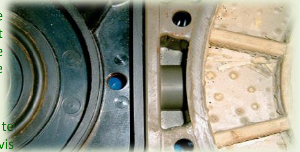
Un corps en chloraflon®, à côté d'un corps en ABS après 10 ans d'exposition au chlore gazeux.
