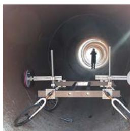
**Outils PipeWalker :** en utilisant PureEM sur un équipement qui progresse le long d'une canalisation vide, le technicien de Pure peut recueillir des données sur l'état des parois tout en procédant à une observation visuelle du revêtement.
