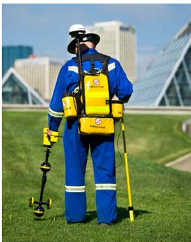
**Cartographie et étude de la corrosion Spectrum XLI :** utilise des récepteurs GPS de précision pour fournir aux propriétaires de canalisations la localisation exacte de leurs biens ainsi que des données sur la corrosivité des sols. Ces données peuvent signaler des zones où la canalisation est plus menacée par la corrosion externe. Il s'agit d'un outil idéal pour localiser des tuyaux métalliques dans des zones à risque où l'alignement est inconnu.
