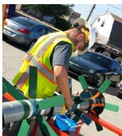
**Plate-forme PipeDiver@** : une plate-forme flexible autonome qui peut être déployée dans une canalisation en service, permettant de recueillir de précieuses données sur l'état avec une interruption minimale du service.
