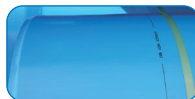
La longueur de limite d'emboîture est la distance entre l'extrémité biseautée du tuyau et la marque repère imprimée.
