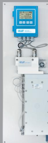
**Conductivité en amont et aval d'un échangeur cationique (CACE) avec module EDI pour régénération continue de la résine**
