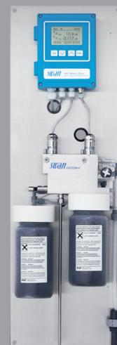
**Conductivité en amont et aval d'un échangeur cationique (CACE) avec colonne de résine conventionnelle**
