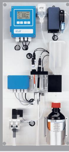
**Mesure en continu du sodium dissous (pour échantillon pH $\geq$ 2)**
