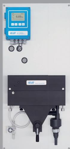
**Mesure en continu de la turbidité sans contact pour le suivi des produits de corrosion (ex : fer particulaire)**
