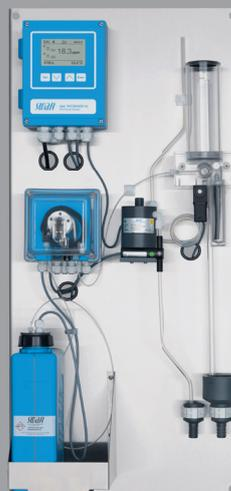
Analyseur pour la mesure en continu des phosphates dans l'eau de chaudière
