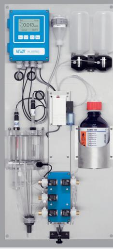
**Mesure en continu des traces de sodium dissous dans les eaux ultra pures et générateur de vapeur**
