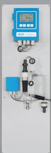
Mesure en continu de l'hydrogène dissous pour le suivi de la corrosion dans les cycles eau-vapeur
