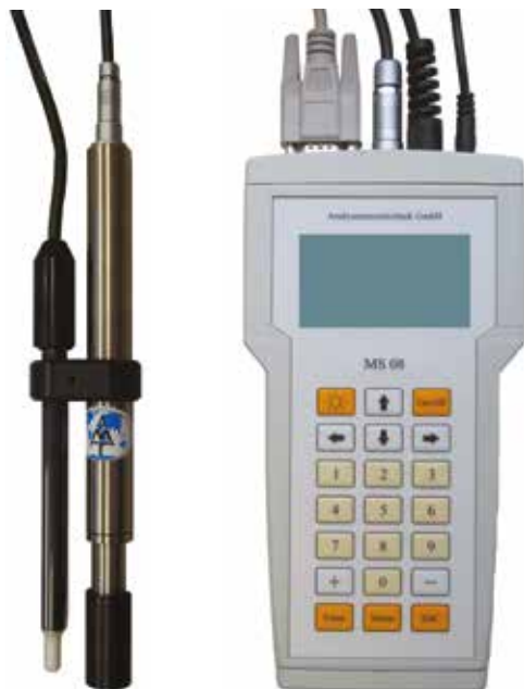
Système multi-paramètres Adapter aux micro-capteurs H 2 S - H 2 - H 2 O 2 - O 2 - O 3
