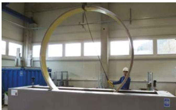
Ci-dessus: test de résistance à l'abrasion. Ci-dessous: test de rigidité annulaire à long terme.
