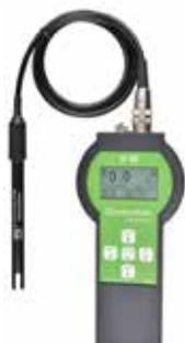
L'appareil LF 40 combine les caractéristiques d'une application mobile sur le terrain avec la précision et le confort d'un appareil de laboratoire grâce à un menu présenté en texte clair, un système d'enregistrement de données intégré et un boîtier IP 65 robuste et étanche à l'eau. Le LF 40 est doté d'une compensation de température automatique pour la mesure de conductivité ainsi que d'une température de référence réglable avec des mesures sans capteur de température.
