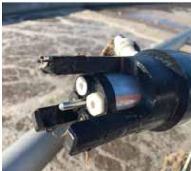
Nettoyage à air comprimé disponible en option pour les sondes IQ Sensor Net. Convient pour un encrassement important. Pour systèmes avec et sans alimentation interne en air comprimé.
