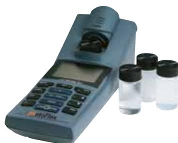
pFotoFlex®: photomètre LED portable pour la surveillance de l'environnement et les analyses de l'eau et de routine dans les laboratoires (mobiles) de service
