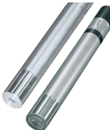
VisoTurb® : sondes optiques de mesure de la turbidité selon le principe néphélométrique conformément aux normes DIN EN 27027 et ISO 7027 pour une utilisation in situ dans l'eau/les stations d'épuration avec système de nettoyage à ultrasons.
