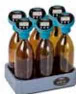
OxiTop®-i (système de mesure : tête de mesure, flacon d'échantillon, agitateur)
