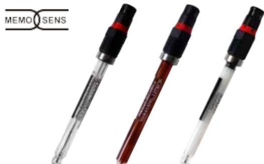
Notre gamme MEMOSENS® contient des électrodes de pH et Redox. Elles sont compatibles avec tous les appareils de mesure disponibles sur le marché se basant sur le protocole MEMOSENS®.
