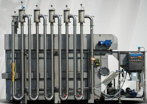
Le Système GEM (Gas-Energy Mixing) de CWT est le futur des technologies de flottation, pouvant être utilisé en tant que traitement primaire physico-chimique ou en tant qu'alternative à la décantation secondaire ou des systèmes de filtration des eaux usées.
