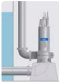
Installation permanente en fosse sèche avec moteur installé à la verticale, raccordement à brides pour la tuyauterie d'aspiration et de refoulement.
