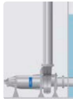
Installation fixe en fosse sèche avec moteur installé à l'horizontale, raccordement à brides pour la tuyauterie d'aspiration et de refoulement.
