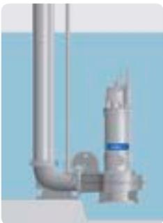
Installation submersible permanente. La pompe est installée sur un pied d'assise avec deux barres de guidage et chaîne de levage.
