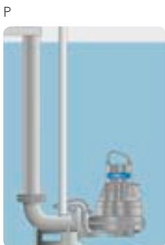
Installation submersible permanente. La pompe est installée sur un pied d'assise avec deux barres de guidage et chaîne de levage.
