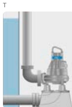
Installation permanente en fosse sèche avec moteur installé à la verticale, raccordement à brides pour la tuyauterie d'aspiration et de refoulement.
