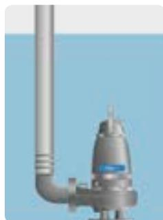
Installation semi permanente. Version polyvalente et facile à mettre en œuvre avec raccord pour tuyau souple ou bride pour tuyau rigide.
