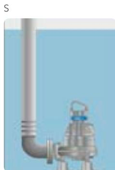
Installation semi permanente. Version polyvalente et facile à mettre en œuvre avec raccord pour tuyau souple ou bride pour tuyau rigide.
