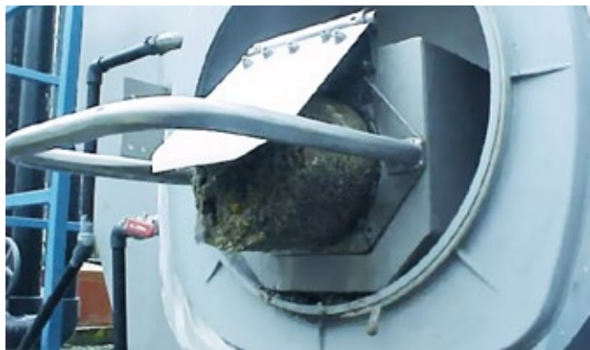
Un compacteur à vis efficace pour un transport des déchets facilité
