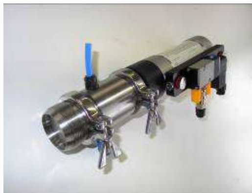
Piston de prélèvement sur conduite
