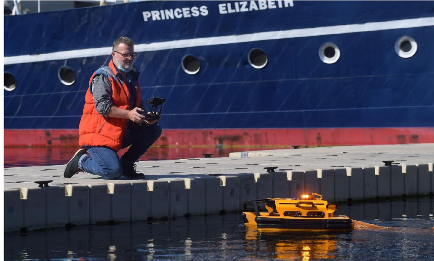
Tractant un filet, le Jellyfishbot permet de collecter les déchets flottants à la surface. PHOTOS MARC DEMEURE
