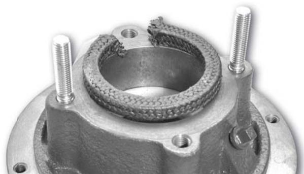
**Figure 41** Mise en place de la deuxième tresse et positionnement des deux bords de coupe inclinés de la tresse.
