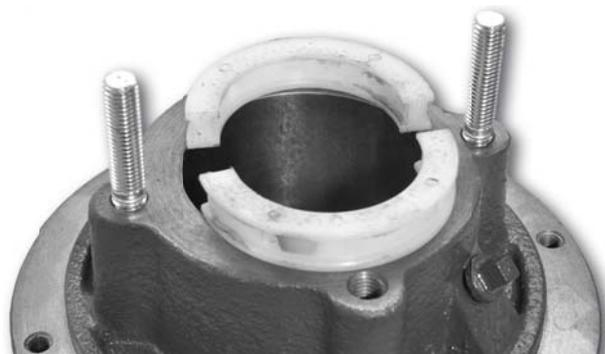
**Figure 40** Mise en place de la lanterne d'arrosage en second
