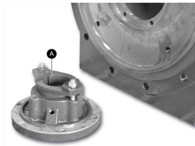
**Figure 36** Le boîtier presse-étoupe déposé.
