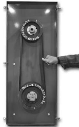
Figure 19 Contrôle visuel de la tension des courroies,
