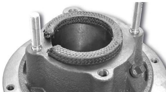
**Figure 39** Mise en place de la tresse et positionnement des deux bords de coupe inclinés de la tresse.
