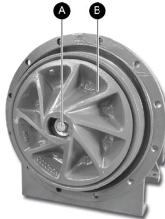
Figure 29 Dépose de l'impulseur.
