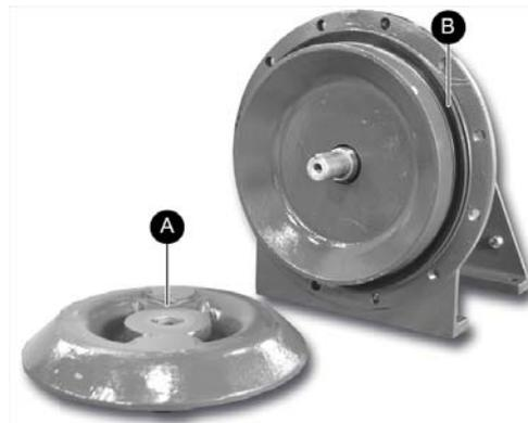
Figure 30 Dépose de l'impulseur (A). Le repère (B) localise le joint du corps de pompe.
