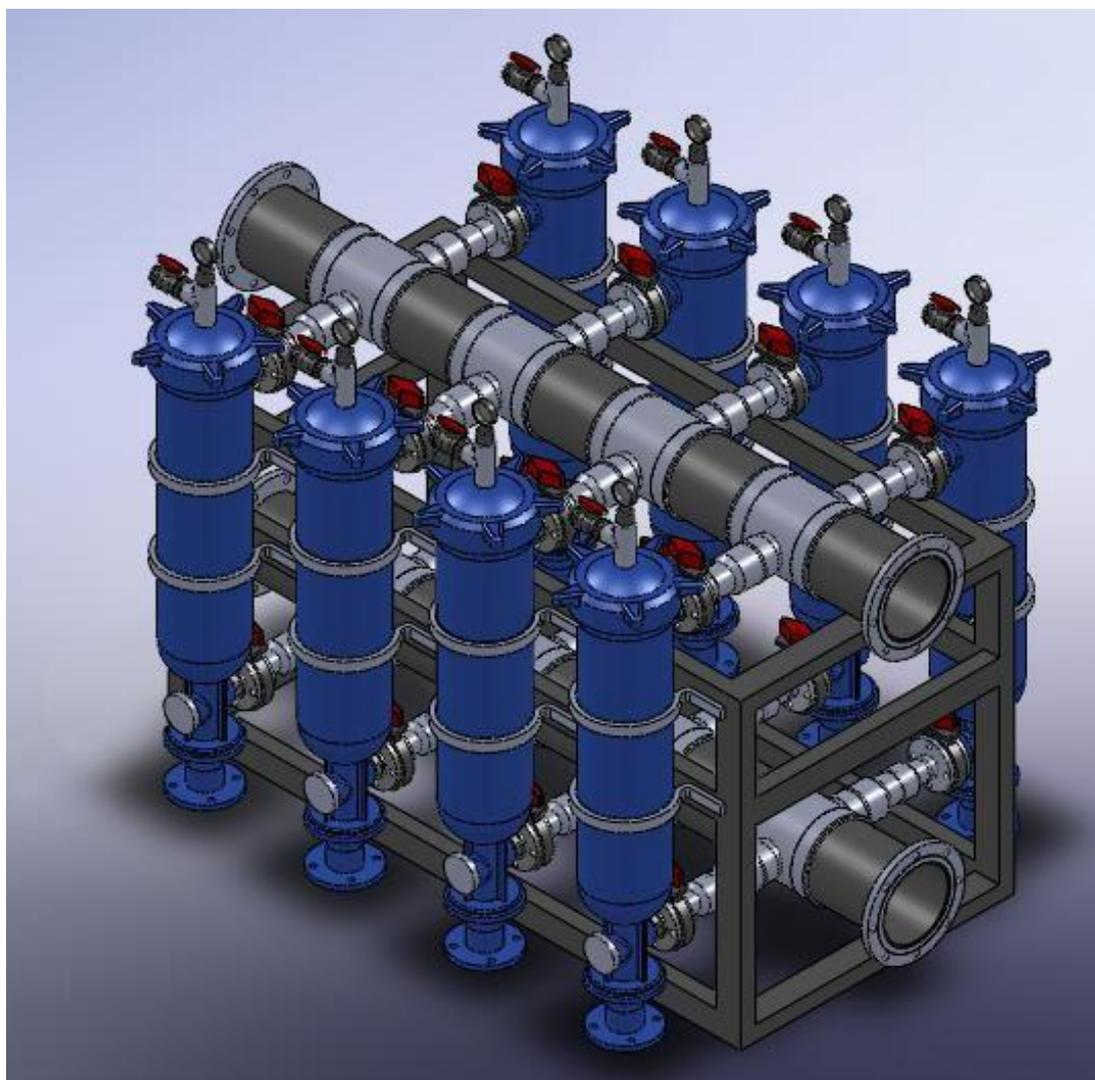
Intervention facile sans interruption de la production lorsque l'élément filtrant est remplacé.
