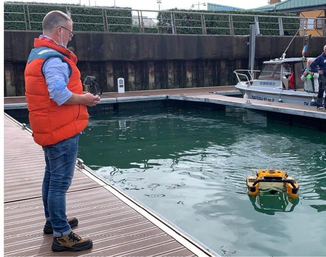
Arnaud utilise un drone flottant équipé d'un filet pour enlever les déchets et les hydrocarbures à la surface de la mer, des étangs ou encore des cuves.
