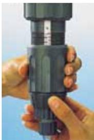
Le réglage du dosage s'effectue en faisant correspondre le haut de la bague de réglage à la graduation souhaitée sur la réglette. La quantité de produit injectée est proportionnelle à la quantité d'eau qui entre dans le Dosatron :
