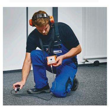
La solution compacte composée des systèmes **AQUAPHON®** et **FERROPHON®** offre aux professionnels de la localisation de nombreuses possibilités de localisation précise de conduites et de fuites dans les bâtiments. Cette solution comprend entre autre le récepteur **AQUAPHON® AF 50** et le générateur **FERROPHON® FG 50**. Une mallette robuste permet de ranger tous les composants du système et de charger en même temps le générateur **FG 50**, le récepteur **AF 50** et le casque.
