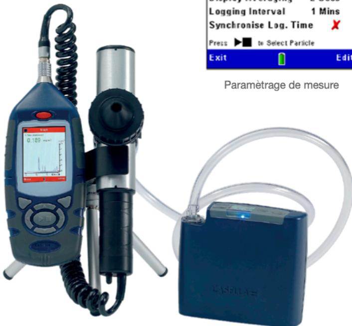
Mesure optique et échantillonnage sur filtre
