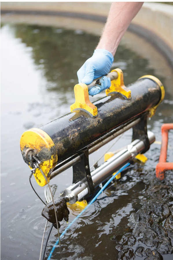
Mesure des nitrates et nitrites en station de traitement, montage sonde OPUS sur flotteur avec nettoyage automatique par injection d'air comprimé
