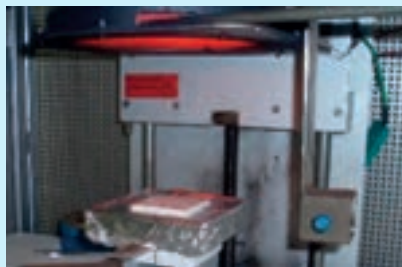
Échantillons en PVC de 5x5 cm, posés dans un four
