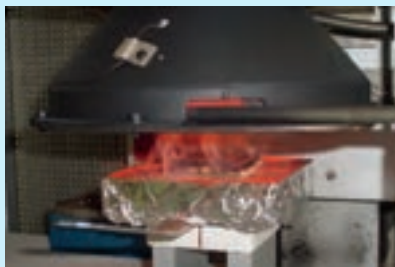
Ces échantillons sont soumis à l'effet de chaleur dans le four
