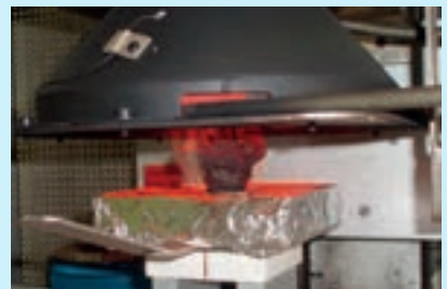
Les échantillons en PVC doivent augmenter leur épaisseur initiale d'au moins 800% pour obtenir la marque NF Me
