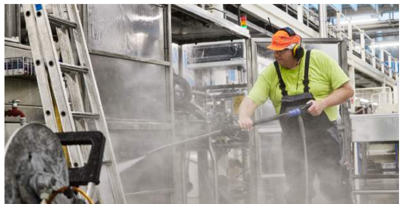
L'eau de traitement est utilisée pour le nettoyage des équipements, des sols, des surfaces, des tuyaux et réservoirs, des laveuses de bouteilles et de canettes, et plus encore à l'intérieur de l'usine.
