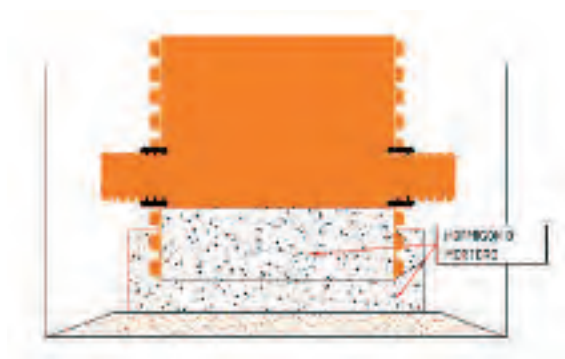
Finition du fond du regard achevé en béton (seulement recommandé sans nappe phréatique)
