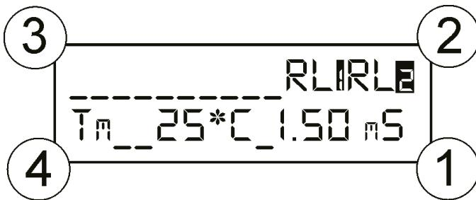
**Nota:** el icono RL2 se transforma en RLA cuando el punto de ajuste 2 se configura con función de alarma.
