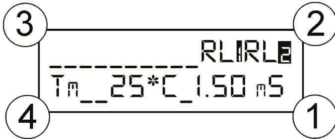
**Bereich 1** = Anzeige chemische Leitfähigkeitsmessung
