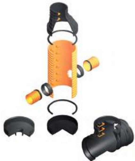
SCHÉMA GÉNÉRAL DE COMPOSANTS DU REGARD SANECOR® AVEC LES DIFFÉRENTES ALTERNATIVES DE CONNEXION AU COLLECTEUR
