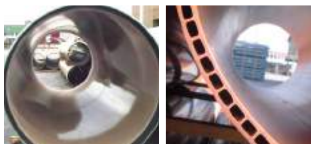
SUR LES TUYAUTERIES EN PLASTIQUE LE COEFFICIENT DE FROTTEMENT INTERNE EST MINIME
