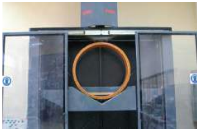
ESSAI DE RIGIDITÉ D'UN TUBE FLEXIBLE
