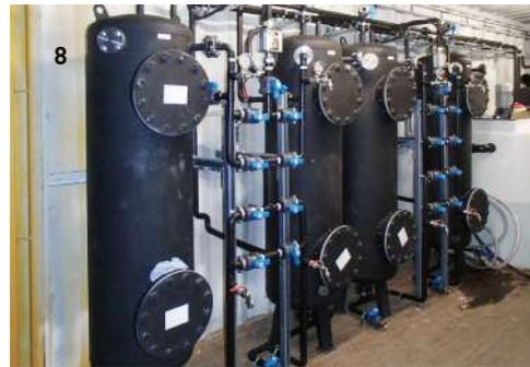
6 UV/O3 Traitement de l'air / 7 Test en laboratoire ISCO / 5, 8, 9 Installations d'essai pour les matériaux adsorbants/ échangeurs d'ions / 10 Essai sur le terrain de l'ISCO, Allemagne du Sud
